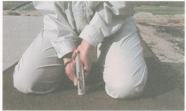
写真-6 平地部での山中式土壌硬度計測定 (樹皮繊維上)
