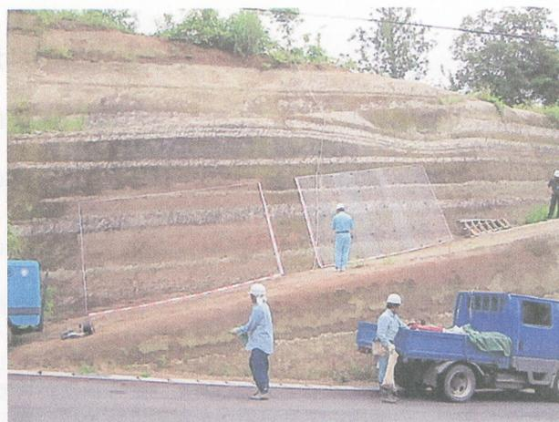
写真-1 海岸隆起した砂岩・凝灰岩の互層（施工前の金網設置は右側、金網なしは左側）面積：10m<sup>2</sup>/個所（5m×2m）
