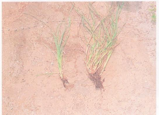
写真-11 1年後の吹きつけ芝の生育差 (左;在来厚層基材, 右;樹皮基材)
