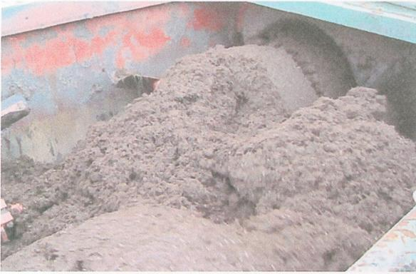
写真-2 樹皮繊維と種子の攪拌混合状況
