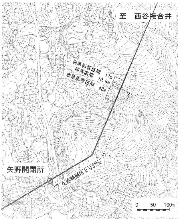
図-2 崩落地点の詳細状況
