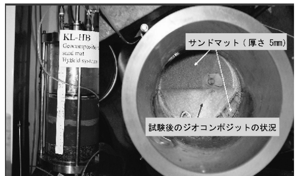
写真-1 HBS敷設後のジオコンポジット(GC)の状況 (目詰まりが見られない)
