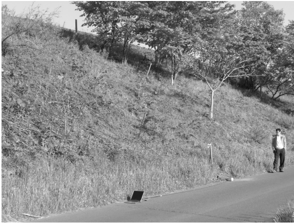
写真-1 検討対象地点における常時微動計測状況
