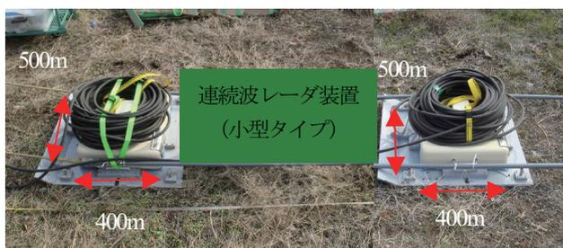
写真-2 連続波地中レーダ装置の小型軽量タイプ<sup>5)</sup>
