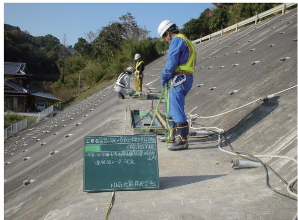
写真-4 地点2（コンクリート張盛土）計測状況
