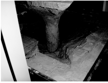
写真-7 圧縮型の試験後のアンカー体
