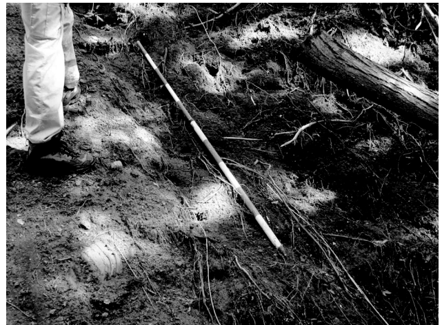
写真-7 クロボクの層にも見られるパイピングの跡(2010年7月24日撮影, 庄原市)
