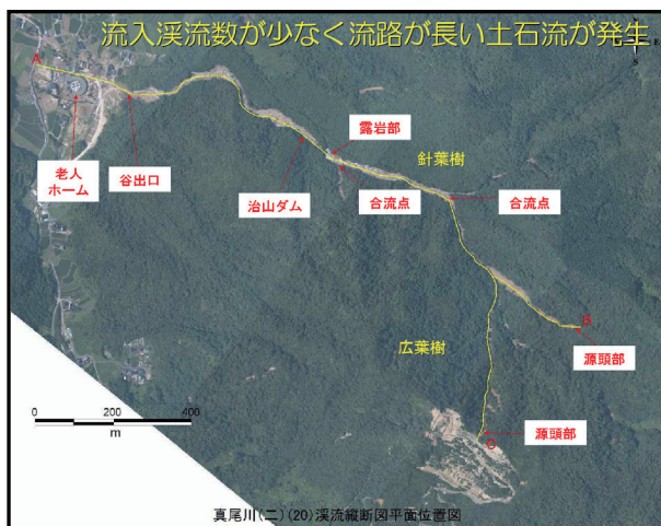
図-5 真尾地区の崩壊・土石流発生状況
