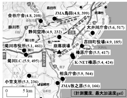
図-2 盛土崩落地点周辺における強震観測点の分布 3)
