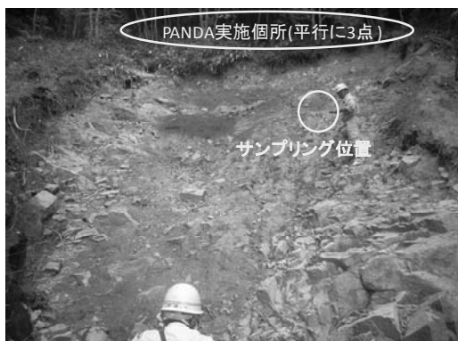
写真-29 源頭部における貫入試験とサンプリング実地位置
