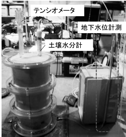
写真-1 地下水水位計測状況(上)
