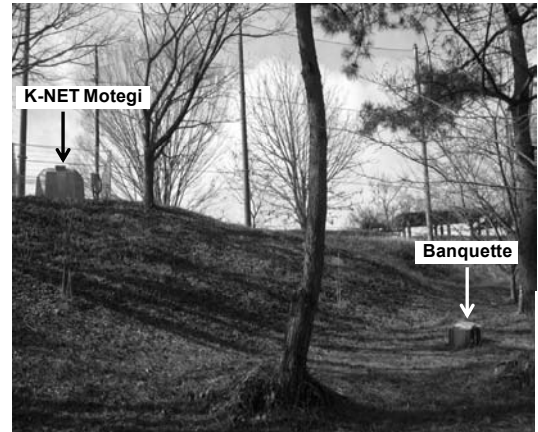
写真-2 法肩(K-NET 茂木)～小段での余震観測状況
