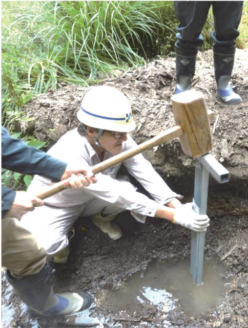
写真-1 ハンマーによるジオスライサーの打ち込み
