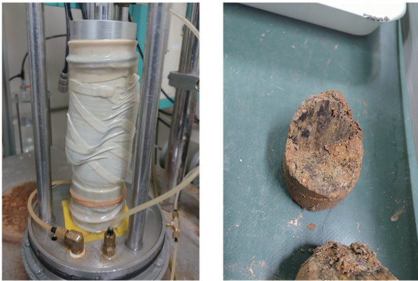
写真-3 黒色薄層土に沿ったせん断破壊
