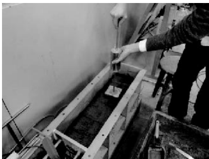
写真-4.2 土槽への試料充填および締固め状況
