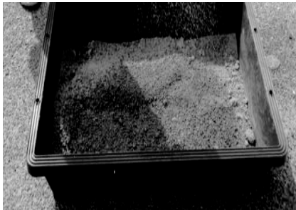
写真-4.1 含水比調整状況
