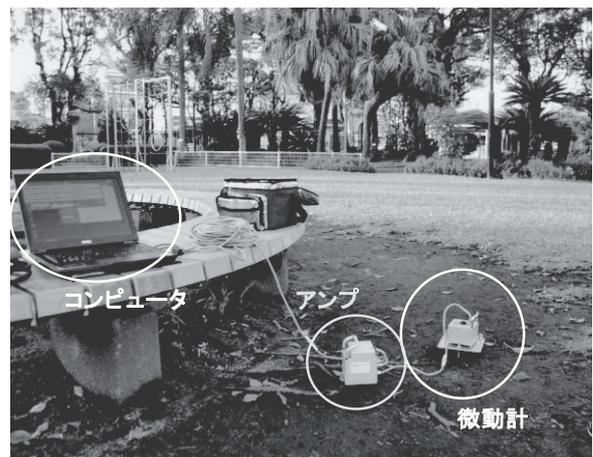
図-3 常時微動計測機器と計測風景
