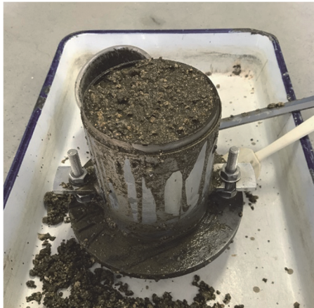
(b) 小屋浦の試料から水が染み出している様子
