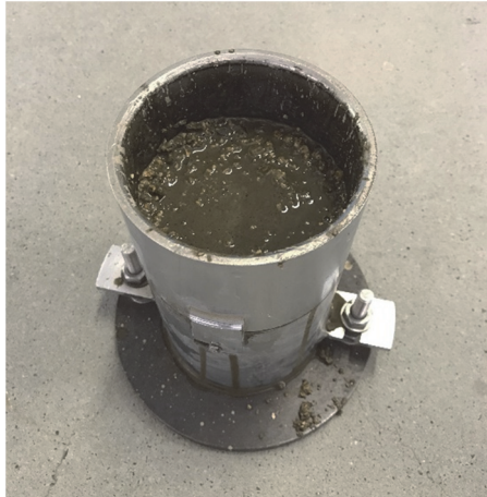
(a) 小屋浦の締固め後に水が染み出す様子
