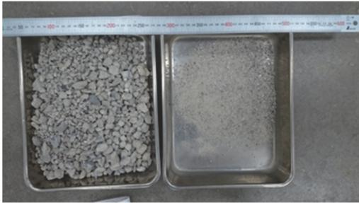
図-6 再生砕石 (破砕試験後)
