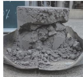
図-11 最大粒径 37.5mm に対する突固めによる締固め試験後
