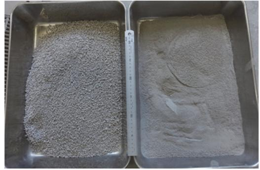
図-9 すりへり減量試験後
