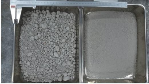
図-5 RPF 木質混焼灰混合材料 (破砕試験後)
