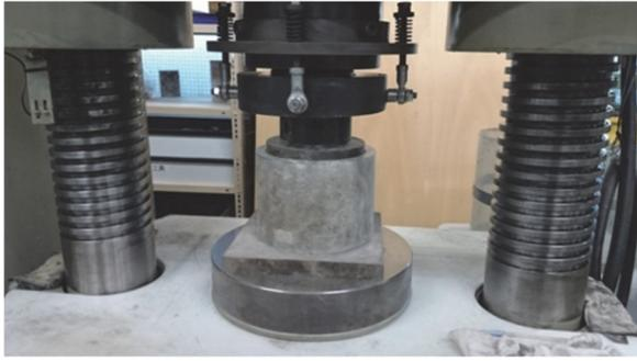
図-4 100kN 破砕値試験状況
