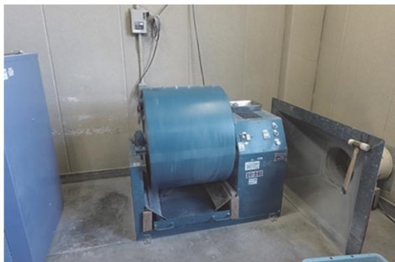
図-8 すりへり減量試験状況
