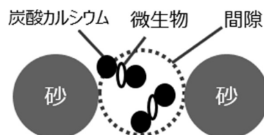
図-4 ミクロマイカ不使用の結晶生成の概念
